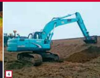
1. 測量用UAV (ドローンなど)。2. 得られた測量データから現地の3次元データを作成する。3. 設計図書から作成する3次元設計データと重ね合わせることで、切り盛りが見える化され、施工量を算出することができる。4. GNSS3Dマシンガイダンスを搭載したバックホー。衛星からのGNSS受信機やチルト(角度)センサーなどを取り付け、オペレーターの操作をサポートする。
