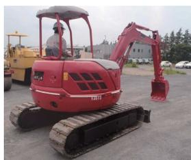
ヘルメットセンサーを付けた作業員が機械の約3m以内に入るとすべての動作が緊急停止。
