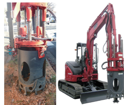
ホルソーは油圧駆動で回転。約80cmの深さまで掘削し、横根を切断します。
