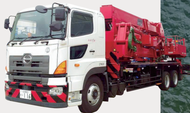
グループで8台保有している国内最大級の橋梁点検車 BT-400
