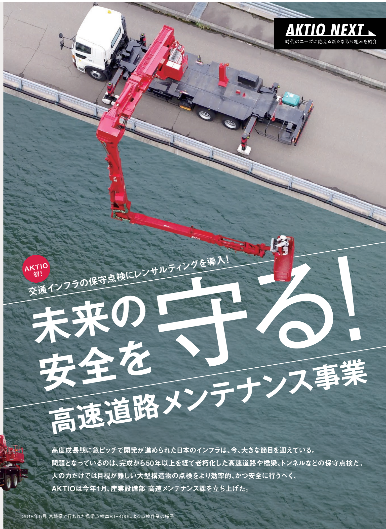
グループで8台保有している国内最大級の橋梁点検車 BT-400
