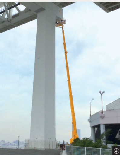
①4つの可動式ブームで橋の下にもスムーズにアプローチ。橋梁点検車BT-400 ②2t車ベースのコンパクトな遮音壁点検車YZ30FC ③作業姿勢のまま移動も可能な高所作業車YX60M ④最大作業床高54m、最大作業範囲37.5mの高所作業車S56XR
