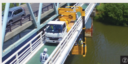
①4つの可動式ブームで橋の下にもスムーズにアプローチ。橋梁点検車BT-400 ②2t車ベースのコンパクトな遮音壁点検車YZ30FC ③作業姿勢のまま移動も可能な高所作業車YX60M ④最大作業床高54m、最大作業範囲37.5mの高所作業車S56XR
