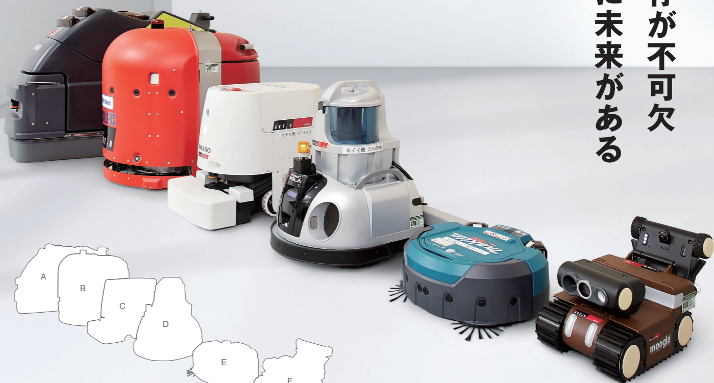
A / 床面洗浄ロボット アマノ SE-500IXII ティーチング方式により熟練作業者の操作を記憶し、自動運転で再現。細かな作業内容まで記憶し、安定した清掃品質で繰り返し作業を行うことが可能。650×1400×970mm 310kg B / 自動床洗浄ロボット 中西金属工業 ロボクリーパー 高度なマッピング機能を搭載した自動走行型のお掃除ロボット。テニスコート9.6面分の広域清掃が可能。病院や体育館、工場、倉庫などの清掃に。925×850×880mm 275kg C / 業務用ロボット掃除機 アマノ RoDC タブレット端末で清掃エリアや運転条件をあらかじめ設定。タブレット操作が苦手な人もボタンひとつで操作可能。日々の清掃に便利なコンパクトサイズ。474×760×565mm 30kg
