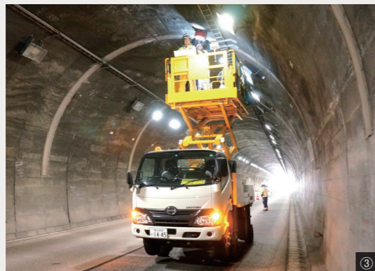
①4つの可動式ブームで橋の下にもスムーズにアプローチ。橋梁点検車BT-400 ②2t車ベースのコンパクトな遮音壁点検車YZ30FC ③作業姿勢のまま移動も可能な高所作業車YX60M ④最大作業床高54m、最大作業範囲37.5mの高所作業車S56XR
