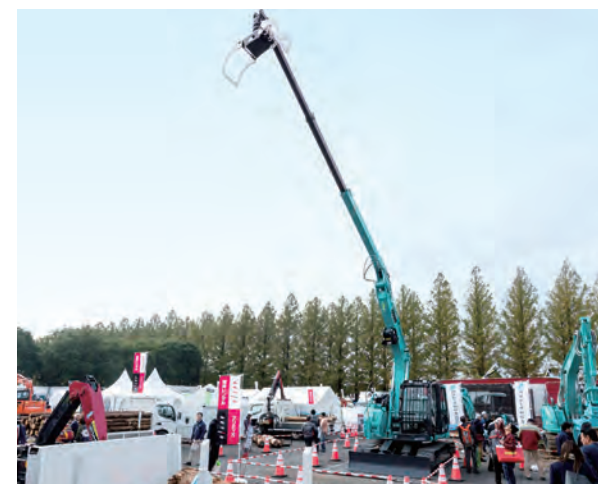
12m先の木材もがっちりつかめる「ロングリーチグラブ」。従来は7~8mだったリーチが飛躍的に向上。効率的な集材作業を実現する
