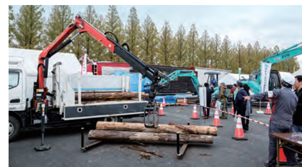
日本初登場の「グラトラ」こと「グラブ付きのトラック」にも注目！3トン車ベースのコンパクト仕様で、スピーディに山奥まで到達できる
