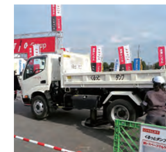
道幅の狭い日本の林道でも、その場でトラック方向転換できる「くるっとダンプ」
