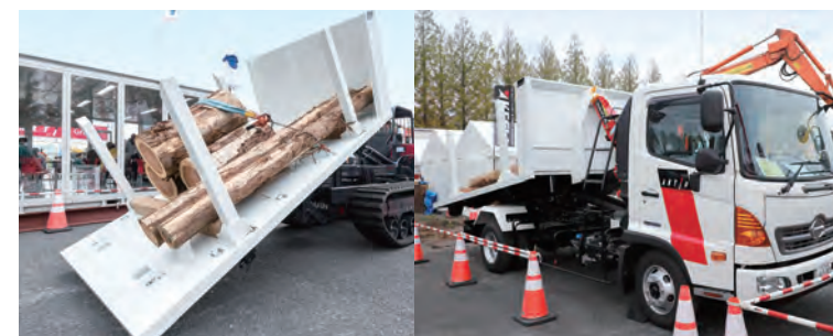
フォワーダからトラックへ、ノンストップ作業を実現する「FUVフォワーダ」「FUVスタントラック」
