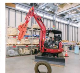
遠隔操作席やコントローラを使用して、後付けでバックホーやキャリアダンプを遠隔操作するシステムのデモを実施。操作は重機および俯瞰できる位置に設置したカメラ映像をモニターで見ながら行う。5G、LTE回線およびスターリンクなど、現場条件に合わせた通信環境を採用し遠隔制御が可能。AIカメラの「ドボレコ®」などを組み合わせることで、さらに安全に配慮した遠隔操作システムを構築することができ、省力化、安全性の確保、生産性の向上が図れる。
