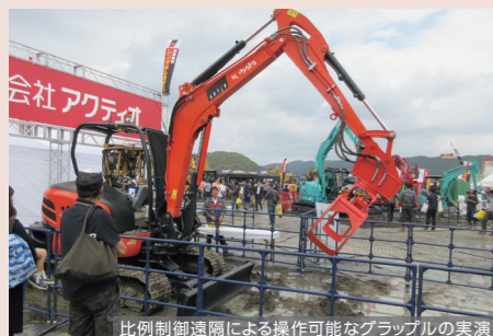
比例制御遠隔による操作可能なグラップルの実演
