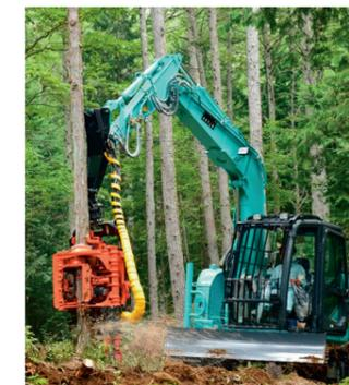
0.25mハーベスタ高性能林業機械による伐倒作業。
