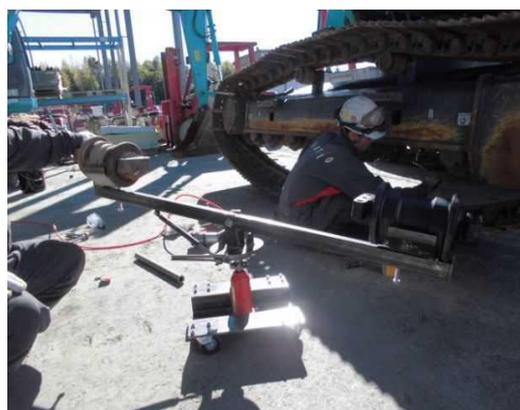
④一度、治具を引き抜き回転させ新品を取り付ける
