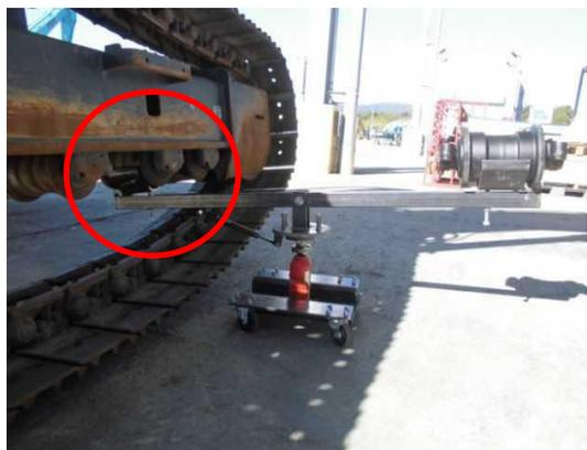
①ダンパー側を交換するトラックローラーに固定
