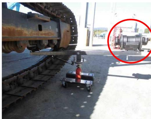
②次に反対側に新品のトラックローラーを載せる
