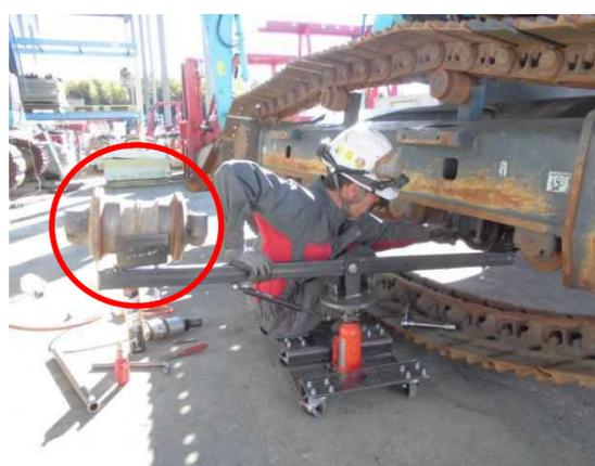
⑥最後に交換したトラックローラーを持ち上げる
