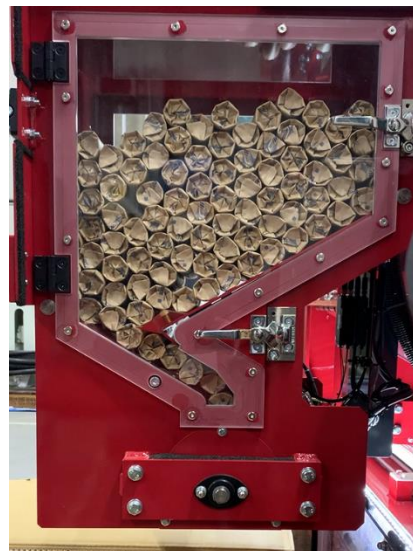
ホッパー内への爆薬格納状況
