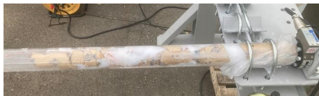
密装填状況(装薬孔内で圧縮された紙巻含水爆薬)
