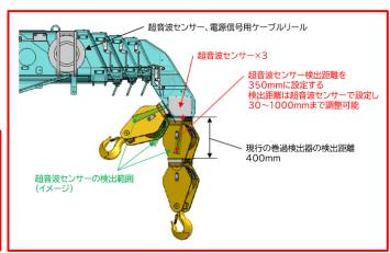
アクティオと前田製作所は、クレーン作業の安全性向上のため、新たな巻き上げ防止センサー「巻上ワイヤ破断防止装置」を共同開発しました。従来のクレーンには巻き上げ防止として巻過検出器が既に搭載されていますが、現場での作業効率を優先するあまり、安全装置を解除して使用する例が多くあります。特に地下鉄工事などでは、巻き上げたままアームを伸ばしてワイヤが切断される事故が頻発していました。
