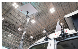
ソーラーパネルを備えた 「太陽光パネル搭載オフグリッド オフィスカー」と 「Starlink Business」 のアンテナ
