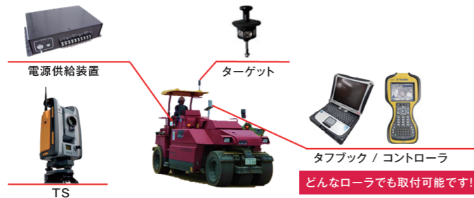
締め管理をガイダンス 締め状態をリアルタイムにナビゲート
