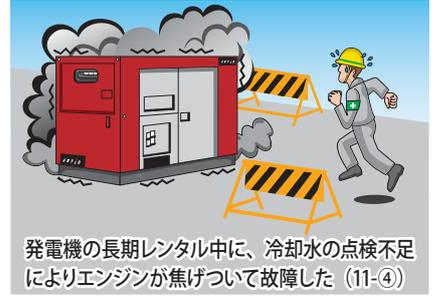
発電機の長期レンタル中に、冷却水の点検不足によりエンジンが焦げついて故障した (11-④)
