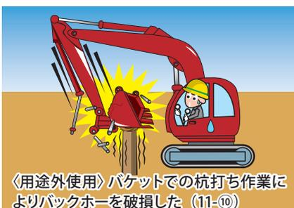
〈用途外使用〉バケットでの杭打ち作業によりバックホーを破損した (11-⑩)
