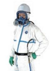
面体内が陽圧に保たれるプレッシュデマンド型エアラインマスクです(プレッシュデマンド形空気呼吸器と組み合わせてお使いください)。エアシャワー時や緊急時に空気の供給を行わない場合、付属のカートリッジを使用してる過式のマスクとして機能します(切換えは自動で行われますので、緊急時にも落ち着いた対応が可能です)。腰ベルトの中圧ホース連結部に、コンプレッサからの空気供給圧力が低下したことを知らせるホイッスル(警報器)付きの安全設計です。
