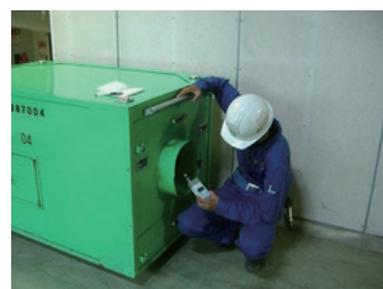
脱臭装置 DD 排気口 計測
