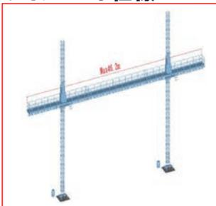
作業プラットフォームを長く取りたい時に能力を発揮します。マスト2本で上下は同調稼働しますので安全面にも配慮しております。
