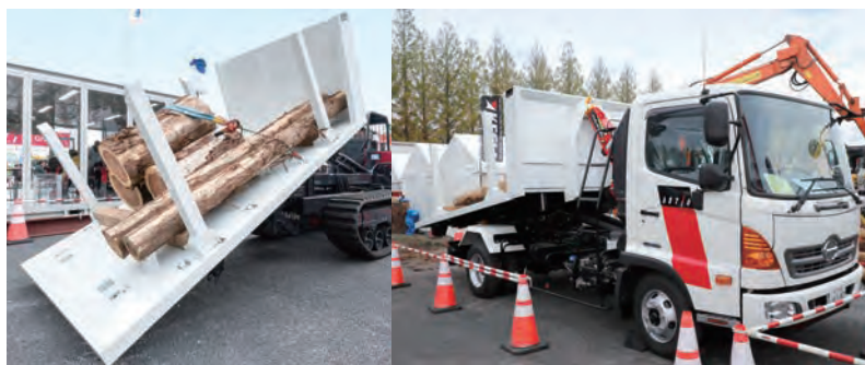
フォワードからトラックへ、ノンストップ作業を実現する「FUVフォワード」「FUVスタントラック」
