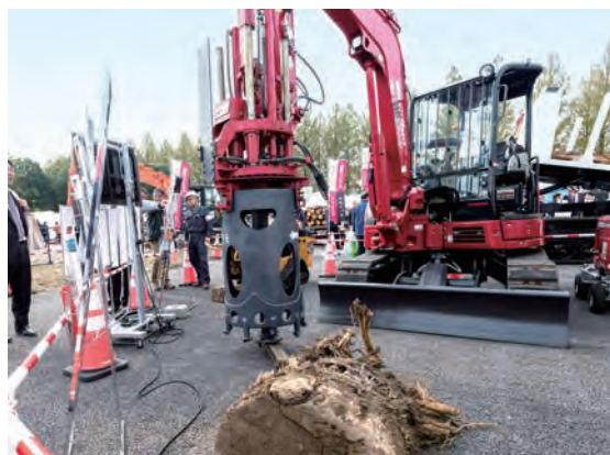
抜根作業の救世主「根こそぎ切るソーII型」。従来の騒音や木くずの飛散問題を解決し、安全・スピーディに作業できる
