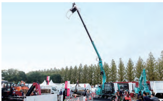
12m先の木材もがっちりつかめる「ロングリーチグラブ」。従来は7~8mだったリーチが飛躍的に向上。効率的な集材作業を実現する
