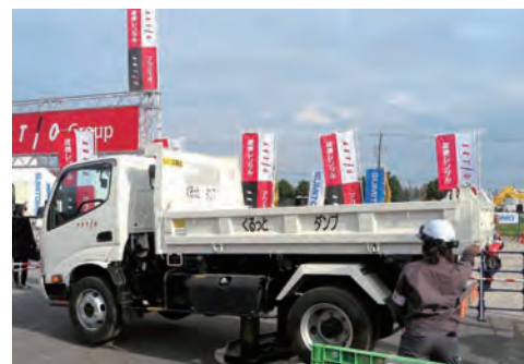
道幅の狭い日本の林道でも、その場でラクラク方向転換できる「くるっとダンプ」
