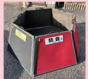
6面囲い設置例
