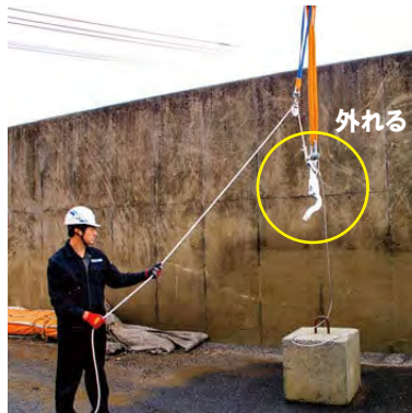
ラフタークレーンの場合、主巻・補巻に取り付ければ、クレーン操作で玉外しが可能
