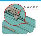
設置個所へ仮置きする。その後、 インパクト (14mmのビット) で固 定する。
