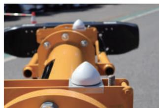
GNSSコンパスを搭載しており、設置したい方向を事前に登録すれば、クレーンが旋回しても吊り荷を設定した方向に保持することが可能
