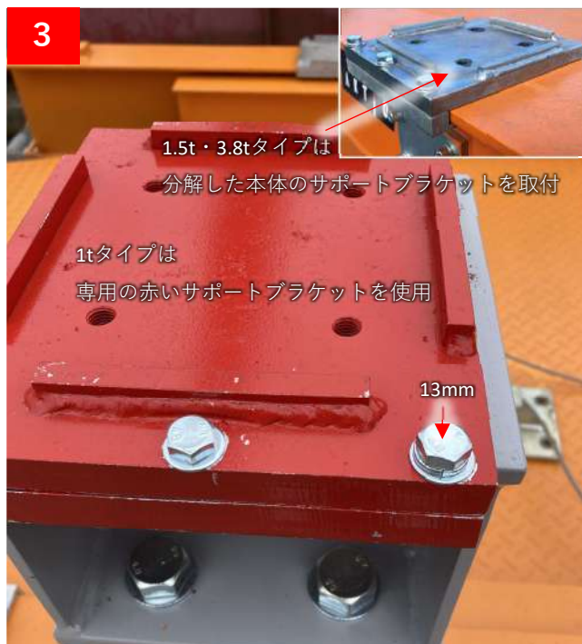
③本体サポートブラケットを分解し、かさ上げブラケットの天端に取り付ける かさ上げブラケット単体であればここで取付完了
